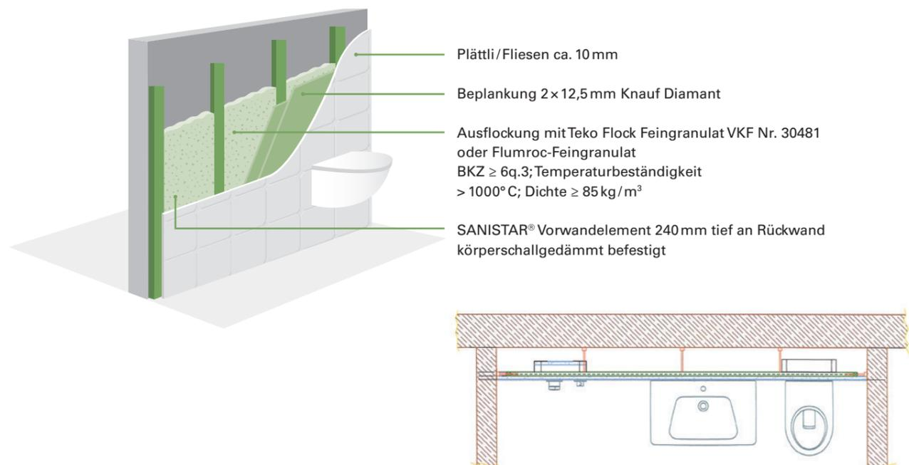
**Körperschall an bestehender gemauerter oder betonierter Wand.**
